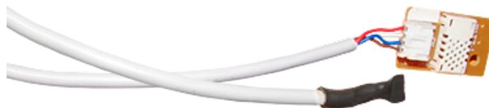
Feuchte- und Temperatursensoren im Inneren der Maschine sind vollständig getrennt und gesondert zu maximieren. Dies erhöht die Lesegenauigkeit und Zuverlässigkeit.
