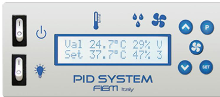
Die elektronische Steuereinheit mit LCD- Hintergrundbeleuchtung ermöglicht eine einfache Bedienung des gesamten Spektrums der unten aufgeführten erweiterten Parameter:
